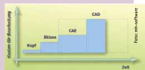
Bild 2 Durch den alternativen Einsatz von CAE sind Änderungen schnell, einfach und kostengünstig realisierbar
